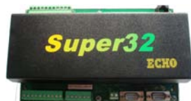
支持无线仪表接入的RTU。
