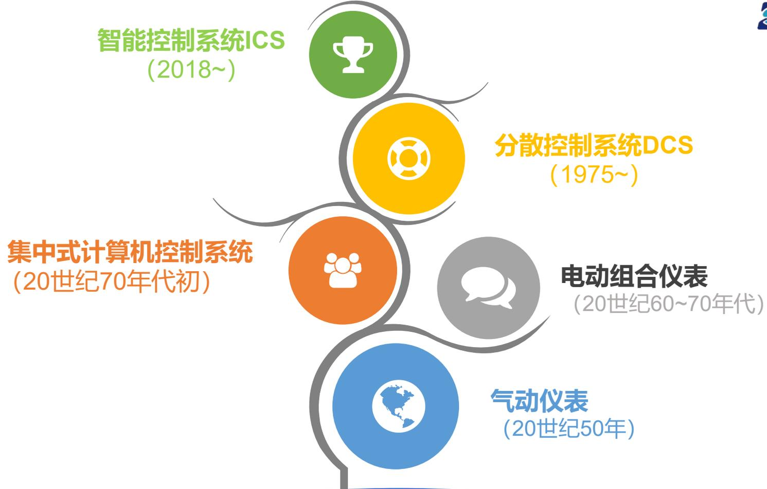
DCS(Distributed Control System)是集通信(Communications)、控制(Control)、显示(CRT)、计算机(Computer)等“4C”技术为一体的多级计算机控制系统，实现生产过程分散控制和集中监控，被广泛应用于电力、石化化工、冶金等各工业领域。
