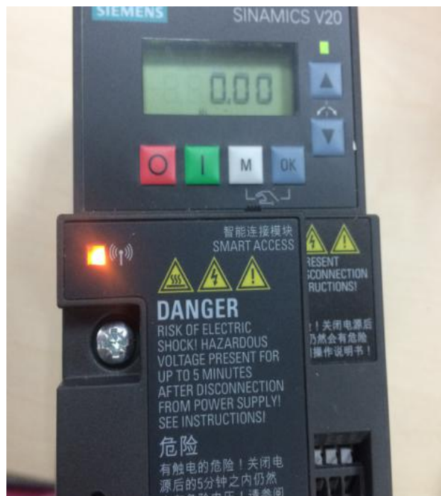
无线模块安装至变频器
