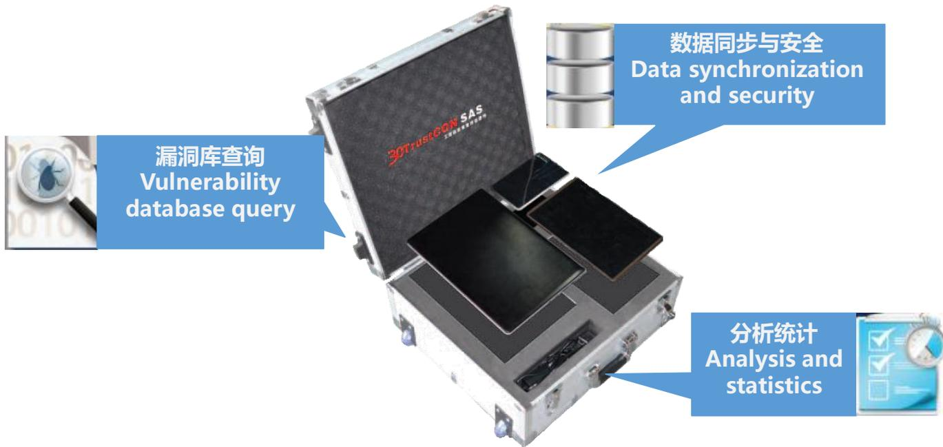
工控安全评估套件是国内首套主要用于工业控制系统的信息安全风险评估和**现场工作管理**的工具。该套件包含任务服务器，现场评估工作站及方便现场工作人员使用的现场评估PAD。通过使用该套件，能实现并**规范工控信息安全风险评估和评估过程**，将部分工作自动化，提高现场工作效率，降低人员工作量。
