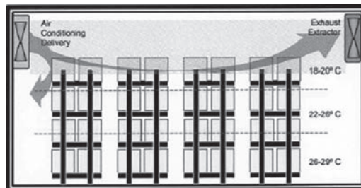
图9 一个蓄电池室的不良设计示意图
