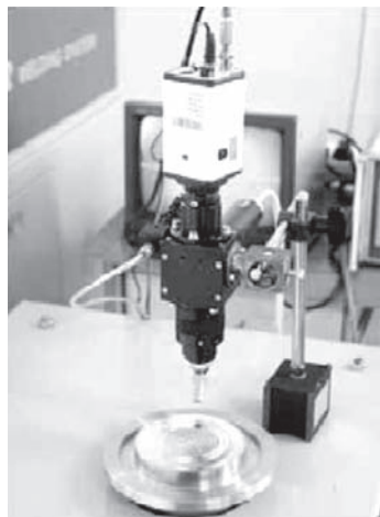
图5 伟岸测器变送器生产线上的精密激光焊接
